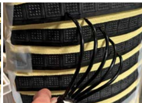
熊の爪を模した道具(金属製)による殴打テスト
